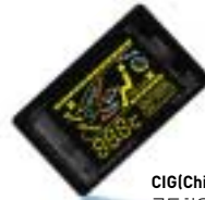
CIG(Chip-In-Glass) VFD 구동칩을 내장하고 있어 조립이 용이하고 휘도가 높아 자동차용 디스플레이로 주목받고 있는 제품
